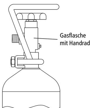
**Hinweis: Der Raum, in dem eine Kohlendioxid-Gasflasche aufbewahrt wird, muss je Kilogramm Flascheninhalt ein Raumvolumen von mindestens 38 m<sup>3</sup> aufweisen!** Dies wären z.B. bei einer Ein-Kilogramm-Flasche und einer angenommen Raumhöhe von 2,2 m mindestens 18 m<sup>2</sup> Grundfläche.
