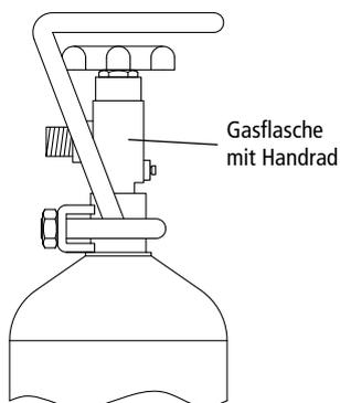
**Hinweis: Der Raum, in dem eine Kohlendioxid-Gasflasche aufbewahrt wird, muss je Kilogramm Flascheninhalt ein Raumvolumen von mindestens 38 m<sup>3</sup> aufweisen!** Dies wären z.B. bei einer Ein-Kilogramm-Flasche und einer angenommenen Raumhöhe von 2,2 m mindestens 18 m<sup>2</sup> Grundfläche.
