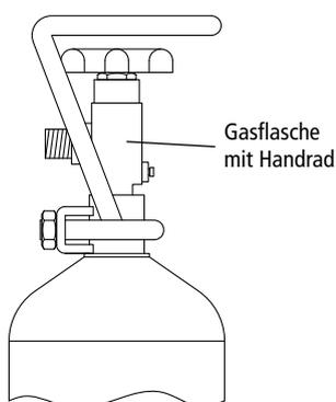
**Hinweis: Der Raum, in dem eine Kohlendioxid-Gasflasche aufbewahrt wird, muss je Kilogramm Flascheninhalt ein Raumvolumen von mindestens 38 m<sup>3</sup> aufweisen!** Dies wären z.B. bei einer Ein-Kilogramm-Flasche und einer angenommenen Raumhöhe von 2,2 m mindestens 18 m<sup>2</sup> Grundfläche.
