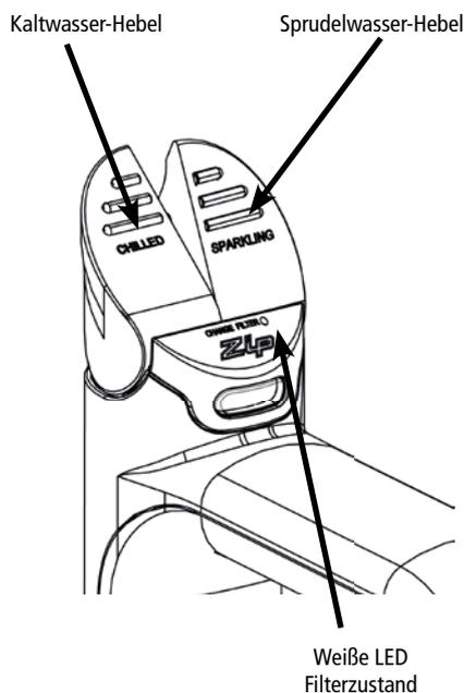
Betätigen Sie die blaue »chilled« Taste, um gekühltes Wasser zu zapfen. Wenn die Taste niedergedrückt wird, fließt gekühltes Wasser solange sie festgehalten wird. Wenn die Taste angehoben wird, fließt Wasser für eine im Menü einstellbare Zeitdauer zwischen 5 und 15 Sekunden. Anschließend muss die Taste in die Aus-Stellung zurück bewegt werden.
